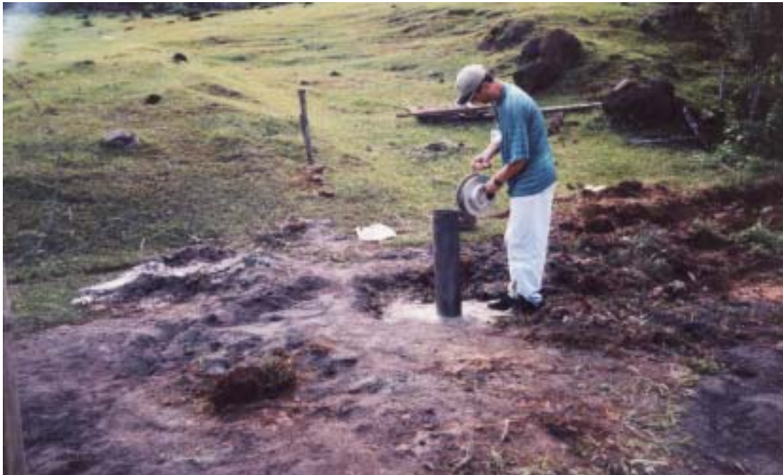
Figura 43 - Medição de nível estático em poço tubular recém perfurado em Águas Frias.
