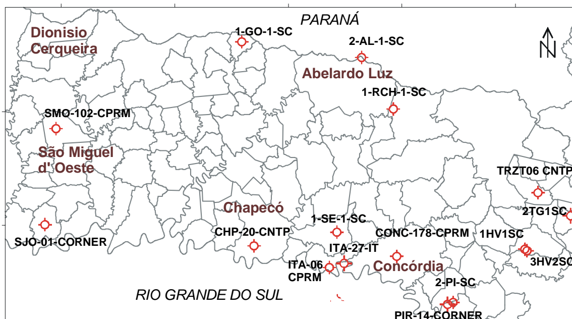
Figura 48 - Poços profundos que captam o aquífero poroso na área do projeto.
