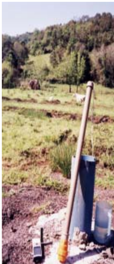
Figura 43 - Medição de nível estático em poço tubular recém perfurado em Águas Frias.
