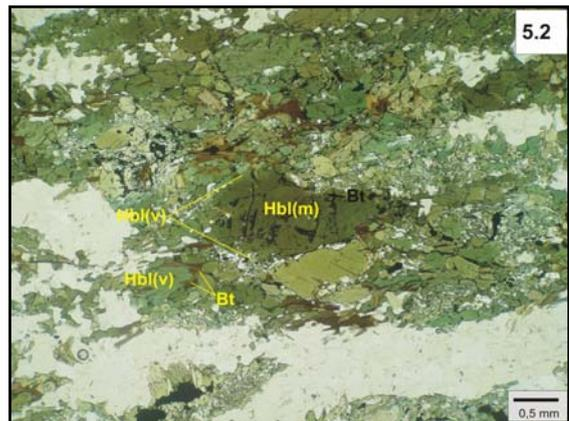
**Foto 5.2:** Porfiroblasto de hornblenda com núcleo marrom sendo substituída na borda por hornblenda verde e biotita, em rocha metabásica da Unidade Arantina em fácies granulito da Nappe Varginha (ponto RD-505).
