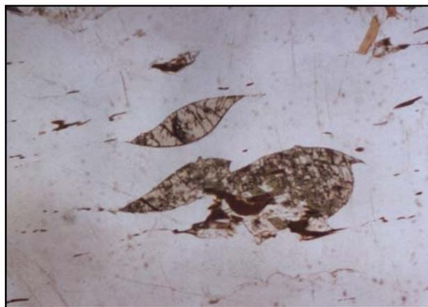
**Foto 4.11:** Indicador cinemático tipo clinopiroxênio-fish, da Fase DB desenvolvidos em ortognaisse milonítico de alta temperatura da Unidade Arantina em fácies granulito, na Nappe Varginha, indicando movimento de topo para NE (ponto MR-249).
