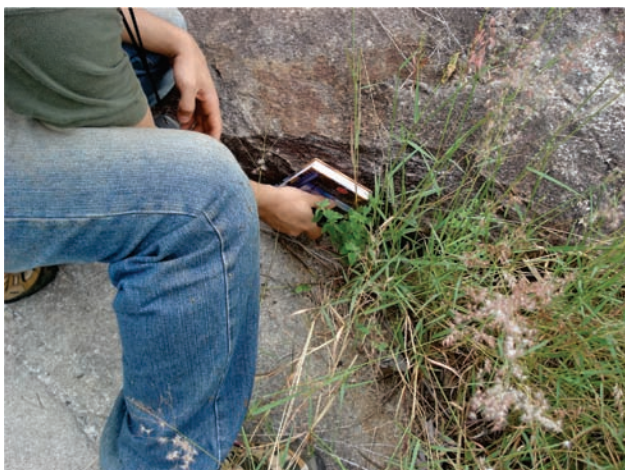
Figura 5.33 – Granito Água Boa (levemente foliado), de típica coloração acinzentada clara. Coordenadas UTM: 811867E e 8241010N
