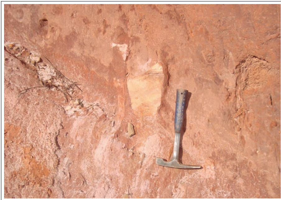
Figura 5.4 – Metadiamic tito alterado, com matriz metassíltica e clastos de quartzito. Coordenada UTM: 789885E e 8257152N
