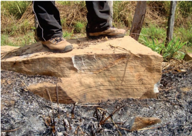
Figura 5.24 – Rocha metagrauvaquiana da Formação Salinas, apresentando colorações claras devidas à alteração. Coordenadas UTM:798648E e 8238693N
