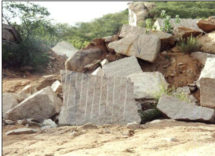
Foto 8.39 - Vista parcial do pátio de blocos da ocorrência 286gr-ro (pedreira), no sítio Junco (Messias Targino - RN). Granito de textura granular grossa, homogênea, de cor bege.
