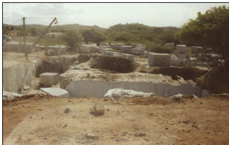
Foto 8.33 - Vista da frente da lavra de rocha calcissilicática, para rocha ornamental, na periferia da cidade de Almino Afonso-RN (ocorrência 289cs-ro).
