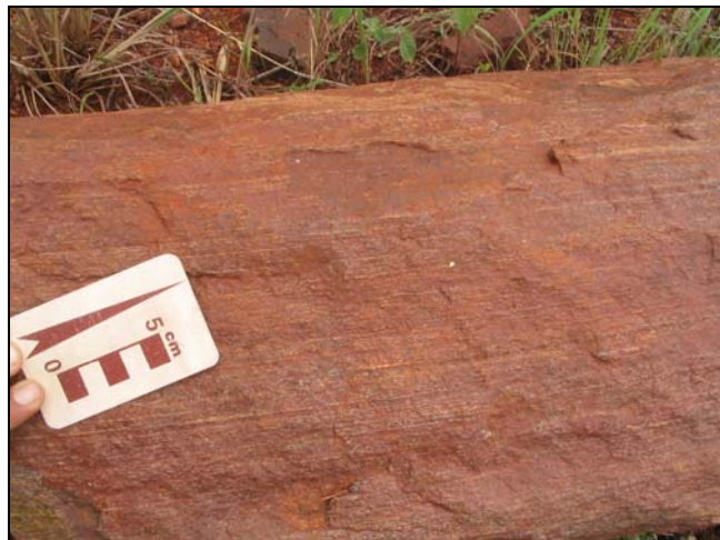
Foto 8.12 - Detalhe do afloramento da ocorrência 248Fe (sítio Santa Inês, Lavras da Mangabeira - CE). Observa-se a alternância de bandas mais ricas em quartzo com bandas mais ricas em minerais máficos, ambas com magnetita.
