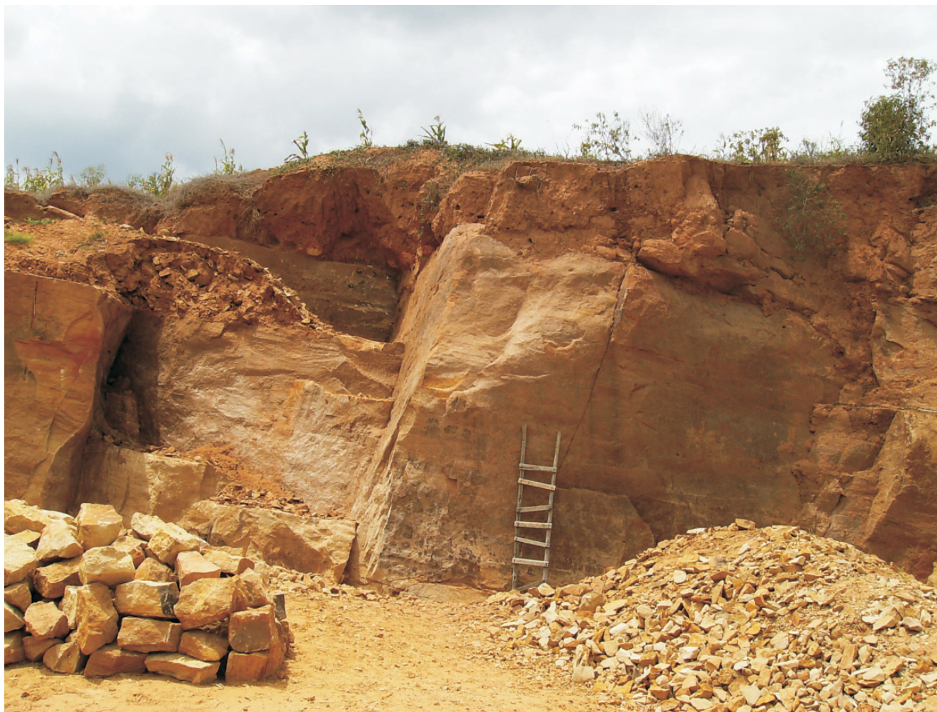
Figura 6.2 - Extração de pedra-de-talhe em arenito do Grupo Ilhas, no município de Tucano.
