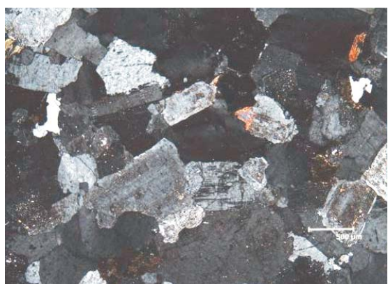
Fotomicrografia 17 - Plagioclásio em cristais hipidiomórficos, com quartzo intersticial e pequenas palhetas de biotita sem orientação preferencial (luz polarizada). Ponto TD-002.
