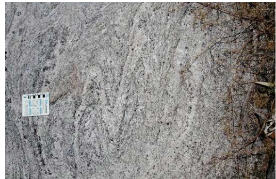
Foto 209 - Aspecto do gnaiss de composição granodiorítica pertencente à Suíte Plutônica Vitória com potencial para rocha ornamental.
