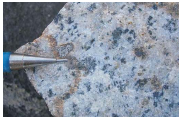
Foto 20 - Detalhe de granófiro monzogranítico rico em sulfeto disseminado. Ponto MC-158.
