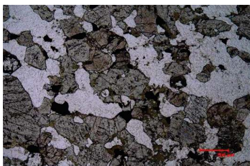
Fotomicrografia 37 - Textura blasto-oftítica. Grãos de piroxênio parcialmente alterados para hornblenda ao longo de planos de clivagem e nas bordas (luz natural). Ponto MC – 073.
