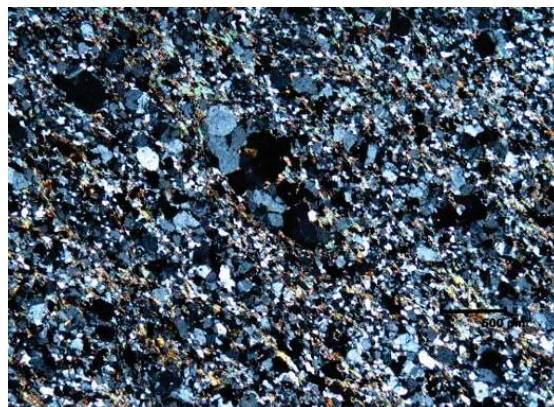
Fotomicrografia 51 – Metariolito pórfírico com textura lepidogranoblástica, localmente glomeroporfiroblástica (luz Polarizada). Ponto PS-135.
