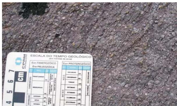
Foto 10 - Metariodacito porfírico com feições de fluxo magmático (ponto MC-156).
