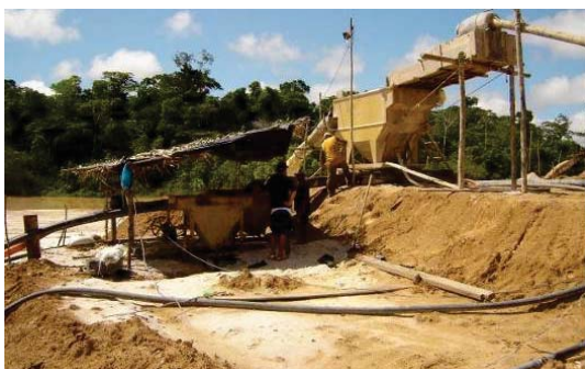
Foto 139 - "Jigs" primário e secundário para concentração gravimétrica de cassiterita. Garimpo do São Francisco - MT.
