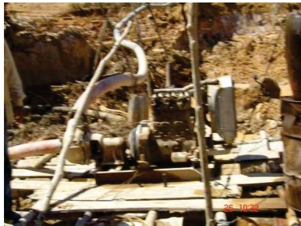
Foto 138 - Bomba de sucção para alimentação do "jig" com material do desmonte hidráulico. Garimpo do São Francisco -
