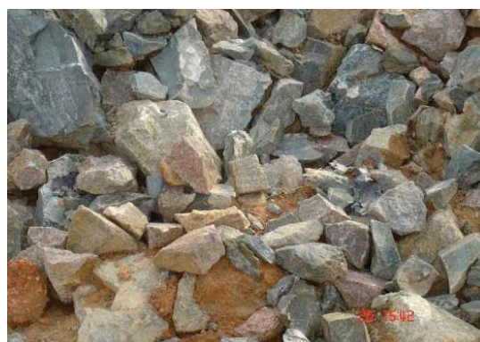
Foto 179 - Pilha de rejeito com fragmentos cujas composições evidenciam os processos de alteração hidrotermal (potassificação, propilitização, sericitização e carbonatação). Garimpo do
