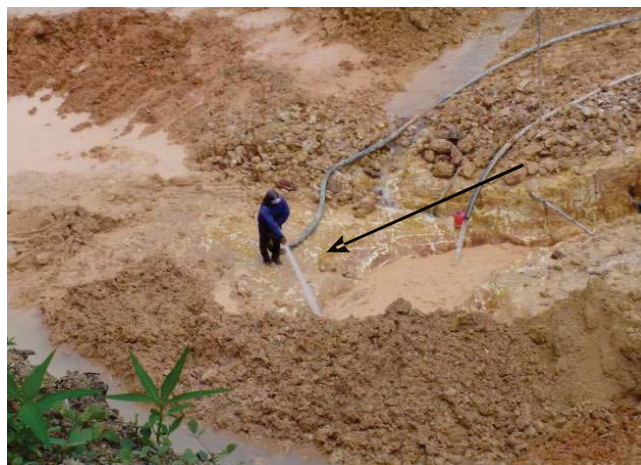
Foto 148 - Lavra do saprólito com stockwork mineralizado em cassiterita. Garimpo do São Francisco - MT.
