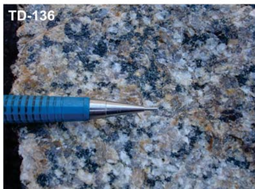
Rocha holocristalina, com granulação variando de média a grossa, mostrando aspectos de deformação, apesar de manter preservada a textura original da rocha.
