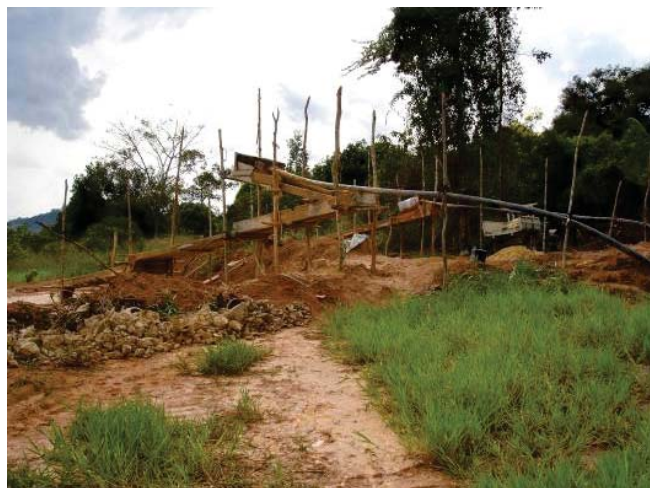
Foto 165 - "Cobra Fumando". Equipamento rudimentar para recuperação de ouro de baixo teor e grande volume.
