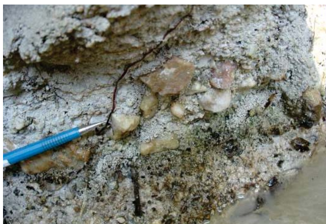
Foto 194 - Material lavrado. Cascalho composto por seixos angulosos de quartzo leitoso em matriz areno argilosa branca.
