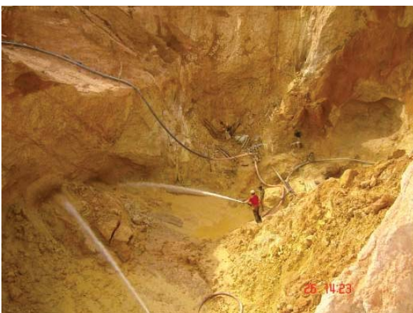
Foto 164 - Desmonte hidráulico para a lavra de minério de baixo teor e grande volume.
