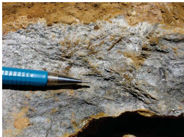
Foto 188 - Fotografia – Biotita tonalito hidrotermalizado (sericita + sílica + sulfeto + Au).
