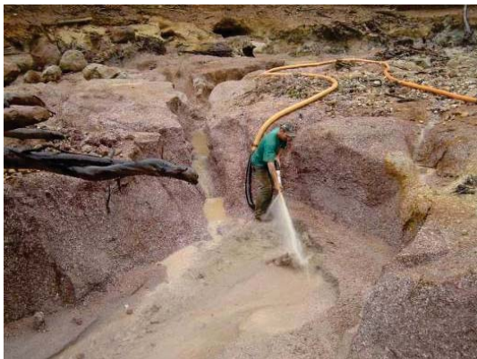
Foto 137 - Desmonte hidráulico das aluviões com jato de alta pressão. Garimpo do São Francisco - MT.
