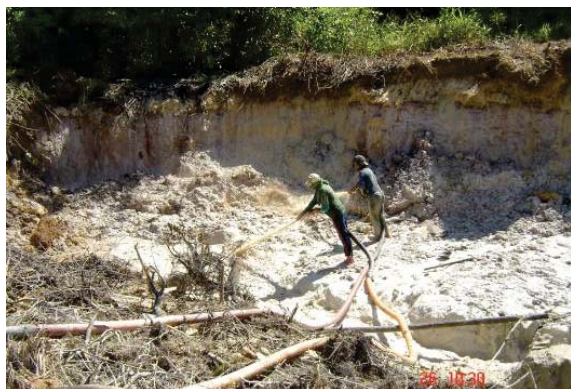
Foto 170 - Desmorte hidráulico do colúvio nas margens do Igarapé do Arrasto. Garimpo do Lazinho.
