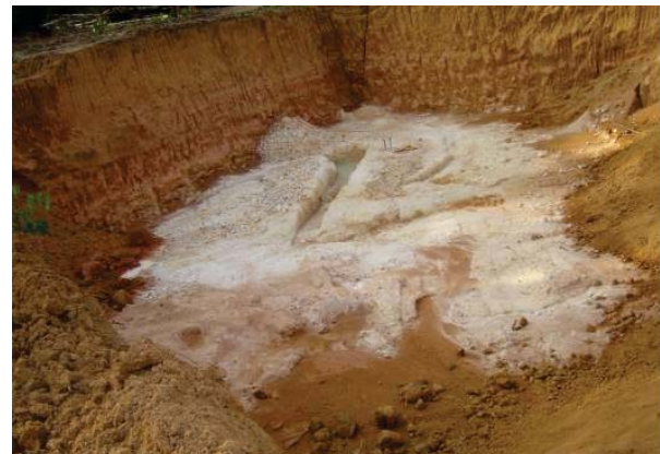
Foto 155 - Garimpo de cassiterita em greisen alojado na cúpula do granito São Francisco - MT.
