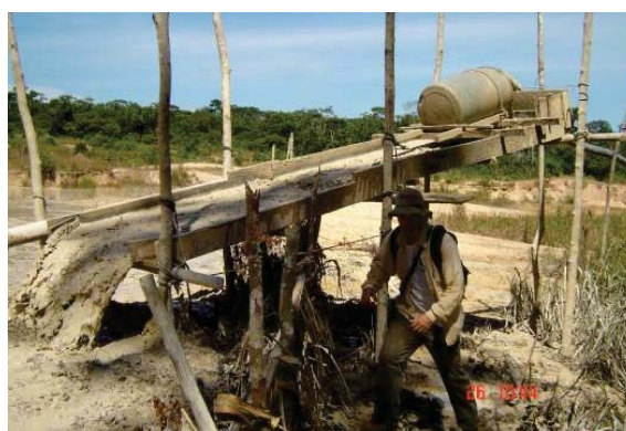
Foto 173 - Planta rudimentar ("Cobra Fumando") para concentração do ouro. Destaque para a alta densidade e velocidade de fluxo da lama que sai da caixa de concentração, responsável pelo baixo índice de recuperação do ouro, principalmente ouro fino e placóide.
