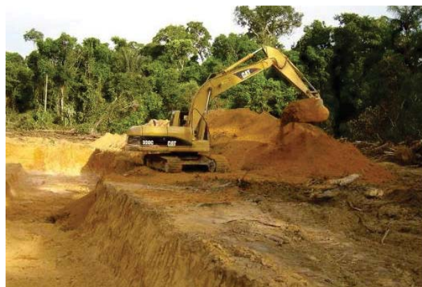
Foto 142 - Decapeamento com retro-escavadeira para a lavra de colúvio. Garimpo do São Francisco - MT.
