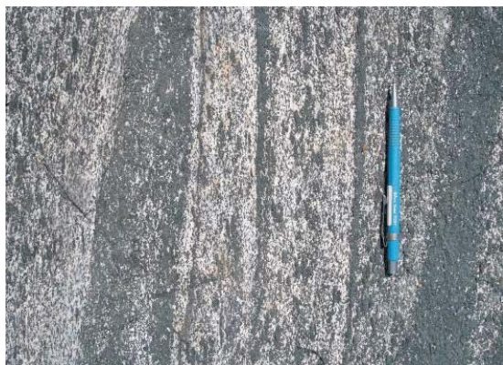
Foto 68 - Estrutura indicativa de bandamento rítmico formada pela alternância de bandas mais ricas em piroxênio (anfíbólio) com bandas mais ricas em plagioclásio. Ponto TD-97D.
