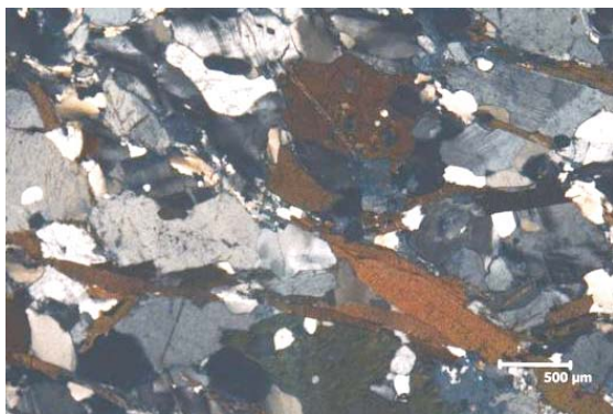
Fotomicrografia 13 - Textura lepidogranoblástica caracterizada por faixas descontínuas de lamelas alongadas e orientadas de biotita intercaladas com níveis granoblásticos de plagioclásio e microclínio, quartzo e hornblenda poiquiloblástica (luz polarizada).
