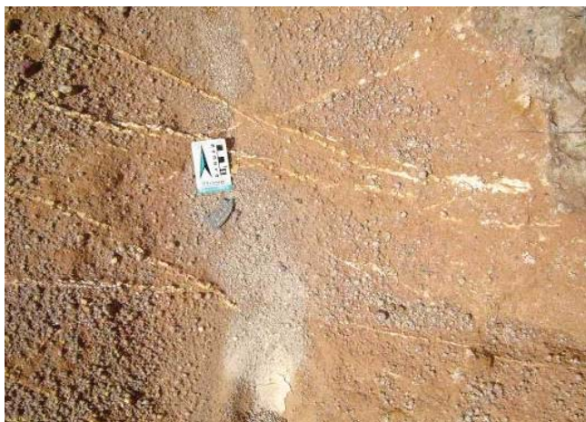
Foto 147 - Solo com venulações de quartzo e feldspato tipo stockwork. Garimpo do São Francisco - MT.
