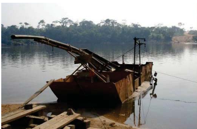
Foto 212 - Draga para extração de areia e cascalho das aluviões do Rio Aripuanã. Município de Colniza – MT.
