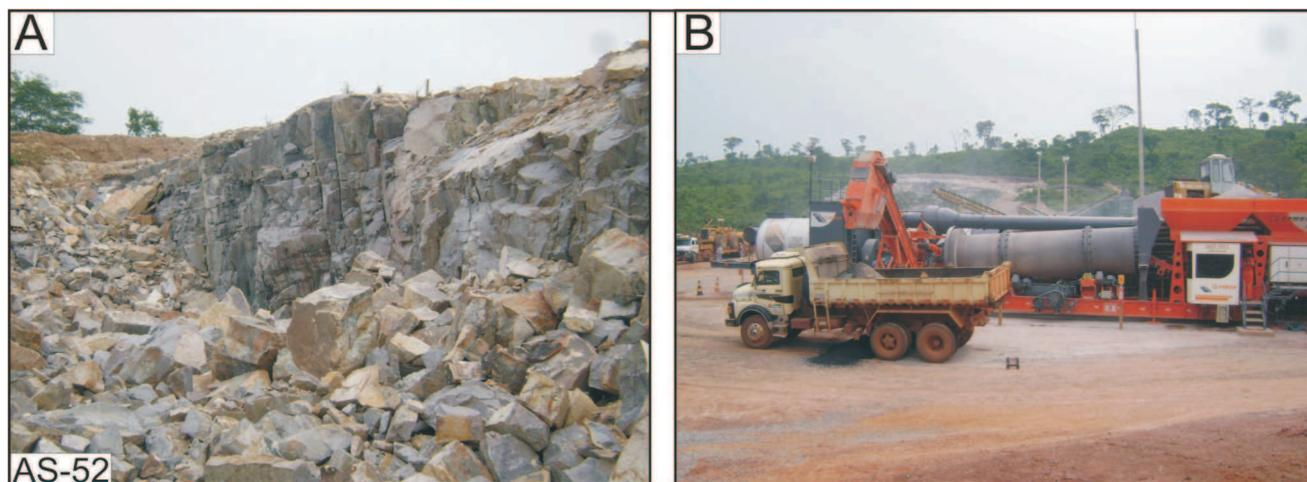
Figura 6.2 - Área de desmonte (A) em pedreira para produção de brita (B) nos arredores da cidade de Confresa-MT.
