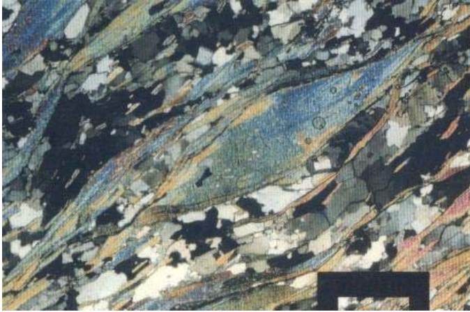
Foto 18: Quartzo-mica milonítico com estruturas do tipo mica-fish. Estação PMCT 41, nicóis cruzados, 25 X.
