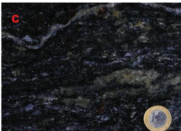
Figura 7.1 - Exemplos de materiais da linha dos azuis, produzidos na Folha Nova Venécia, cujos nomes comerciais são Granito Blue Valley (a), Granito Blue Wave (b) e Granito Azul Brasil (c)
