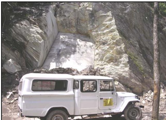
Figura 50: Local de retirada de bloco de quartzo – muscovita milonito para teste de aproveitamento como rocha ornamental. Fazenda Sobrado, Folha Cavalcante.
