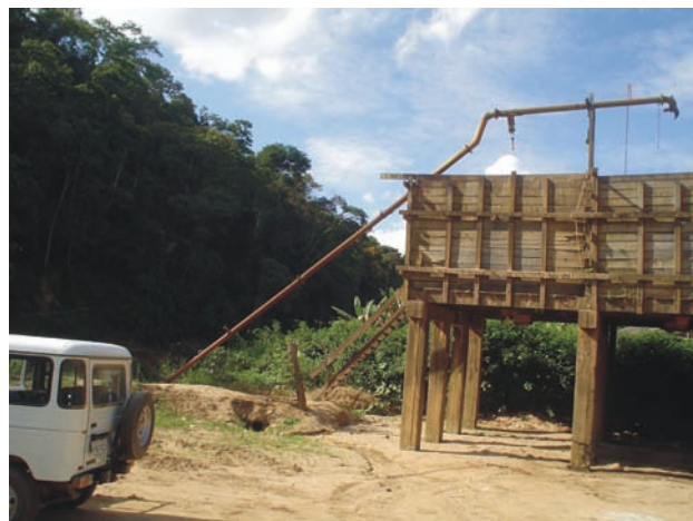
Figura 7.2: Silo de madeira para o armazenamento de areia extraída do Rio Preto, município de São José do Vale do Rio Preto
