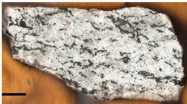
Figura 4.1 – Foliação de ortognaisses da Folha Nova Friburgo, formada por aglomerados planares de biotita e hornblenda, em matriz de grão grosso, quartzo-feldspática. Face serrada de amostra da estação DB-TUP-58, ortognaisse granodiorito da Suíte Serra dos Órgãos. A barra horizontal preta mede 1 cm
