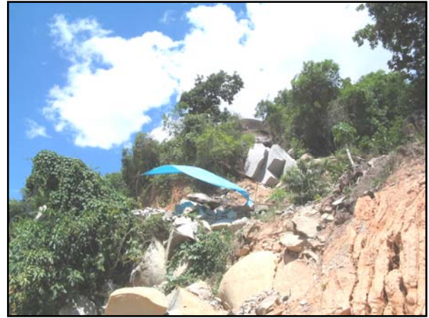
Figura 67: Exploração de rocha (matacão) para a confecção de paralelepípedo em Coqueiral, MG.
