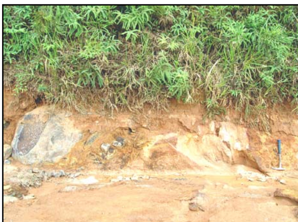
Figura 34: Metamafito (bloco escuro e solo ocre) invadindo granito (branco). Ponto N- 369 (UTM 04900008 e 7668860), Folha Nepomuceno 1: 50.000.
