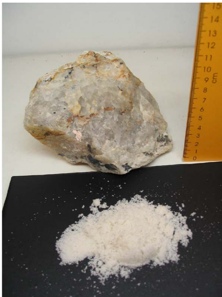
Figura 6.12- Amostra de quartzito recristalizado e moído utilizado na fabricação de vidros, Quatis-RJ.
