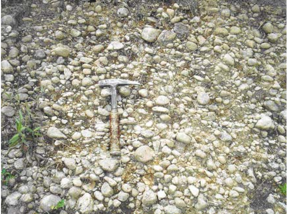
Figura 5.9: Conglomerado com seixos imbricados da base da Formação Ribeirão dos Quatis, corte da Ferrovia do Aço entre os km 18+440 e 18+560, UTM 0580206/7521528, município de Quatis/RJ (Foto Renato Ramos – 2005).
