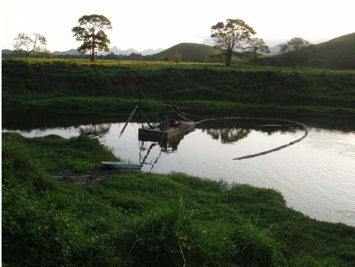
Figura 6.6- Extração de areia com draga em rio de planície, Angra dos Reis, RJ.
