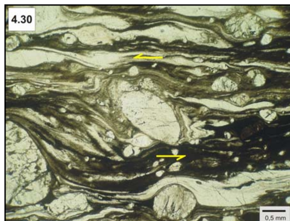
Foto 4.30: Porfiroclasto de feldspato com quarter folds desenvolvidos em ortognaise do embasamento milonítico ao longo da Zona de cisalhamento Conceição da Pedra, indicando movimentação reversa com topo para NW (ponto RD-752).
