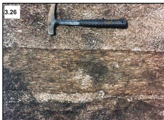
Foto 3.26: Granito Serra da Pedra Branca com nível decimétrico com forte foliação tectônica subparalela a orientação preferencial de fenocristais de feldspatos nas porções pouco deformadas (ponto RD-765; escala: martelo de 30 cm).
