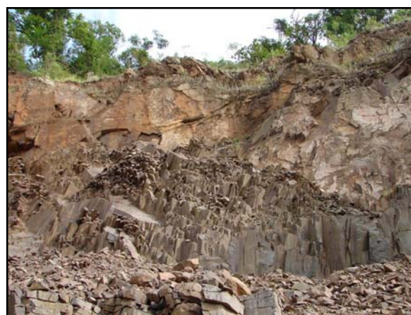
Figura 4.40: Pedreira de rocha basáltica explorada a partir de um sill de composição basáltica (Estação PG 400).
