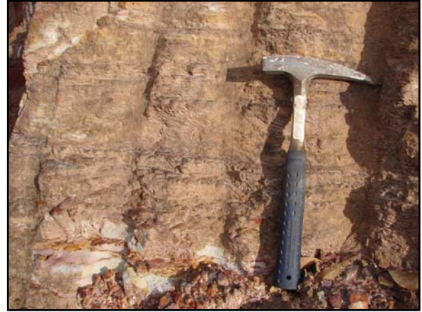
Figura 4.3: Siltitos intercalados com níveis arenosos e cortados por um padrão de fraturamento segundo direção 222° mergulhando 84° para NW.
