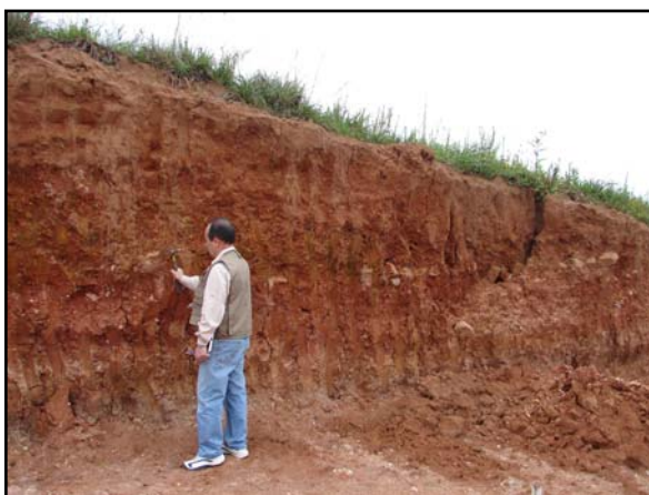
Figura 4.5: Afloramento característico do Sub-grupo Estrada Nova com predominância de siltitos e argilitos arroxeados na base sobrepostos por espessos depósitos coluvionares. Estação PG-426.
