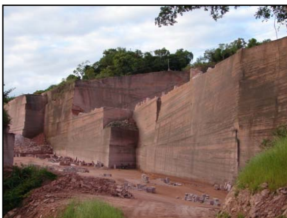
Figura 5.7: Fotografia de pedreira ativa de arenito Botucatu (Estação PG-552).
