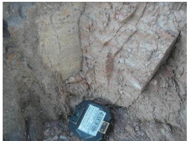
Figura 5.11 – Metargilite da Fm. Serra de Santa Helena, encontrado na porção norte da Folha Curvelo 1:100.000. É possível observar a laminação plano-paralela marcada pela intercalação entre lâminas de coloração diferente. UTM N: 7941786 / UTM E: 558288
