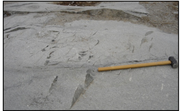
Figura 3.19: Aspecto do geral do Granito Cabanas em pedreira para exploração de britas e paralelos. Planos em destaque são falhas com direção 42Az/subverticais e apresentando lineação 34°/324Az.
