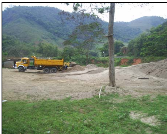
Figura 6.5: Caminhões sendo carregados por areia retirada por draga do leito do Rio Preto - MG. Ao fundo pode ser observado erosão do terraço.
