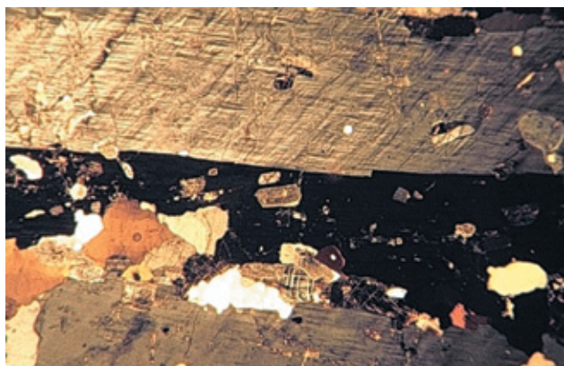
Figura 3.54 – Textura inequigranular porfirítica na facies bandada do Granito Pedra Branca. Polarizadores Cruzados (40x). (Qtz = quartzo; Mic = Microclina; Plg = Plagioclásio; bio = Biotita)
