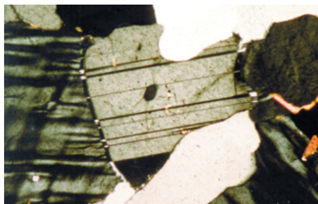
Figura 3.53 – Processo de sobrecrecimento sintaxial pode ser observado na interface entre microclina e plagioclásio. Facies média-homogênea do Granito Pedra Branca. Polarizadores Cruzados (40x) (Qtz = quartzo; Mic = Microclina; Plg = Plagioclásio)
