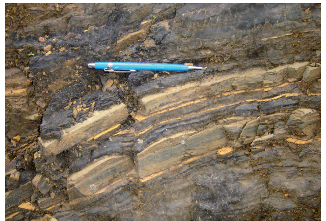
Figura 4.30 – Metamarga com acamamento milimétrico a centimétrico da formação Gorutuba; estrada entre Apiaí e Iporanga, proximidades do bairro Palmital (Apiaí, SP).
