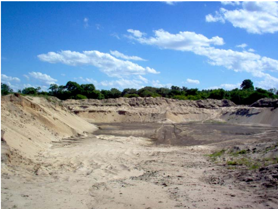
Figura 54 – Aspecto geral de cava para extração de areia em depósito de canal abandonado do Rio Vacacaí. Ponto HZ-308, Passo das Tunas, Município de Restinga Seca.
