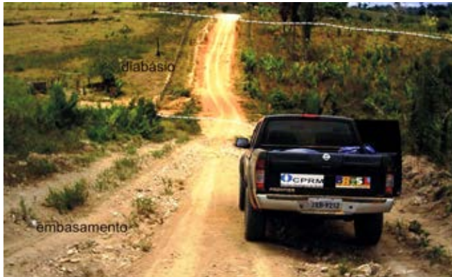
Figura 3.32 – Contraste pedológico brusco assinalando os diques básicos do Diabásio Rio Pajeú, com espessuras de dezenas de metros.
